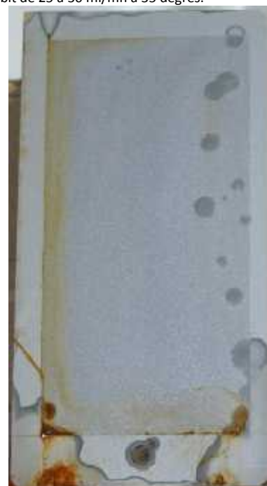
Résultat après 650 heures en ambiance saline agressive humide à 35 °C
